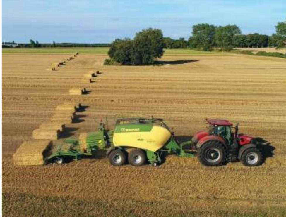
Für eine effiziente Ballenlogistik: Die GPS gesteuerte, automatische Ballenablage quer zur Fahrtrichtung bietet Krone nun für den Ballensammelwagen BaleCollect an. Foto: Krone
