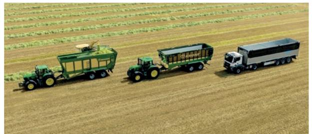
auch über den in der Heckklappe integrierten Kornschieber entladen. Die horizontale Entladung per Schubboden gewährleistet einen sicheren Fahrzeugzustand ohne Umsturzgefahr. Außerdem lassen sich alle Funktionen direkt aus der Fahrzeugkabine mithilfe der Funkfernbedienung ausführen – das ist nicht nur komfortabel, sondern es macht den Fahreralltag auch deutlich sicherer.
