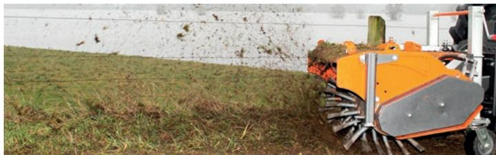
Für saubere Ergebnisse und eine hohe Flächenleistung bei der Wildkrautbeseitigung auf befestigten Wegen und Flächen sorgt die neue Wildkrautwalze, welche für die Kehrmaschine FKM 13060 und 15060 erhältlich ist. Die schwere Stahlwalze ist mit 46 bzw. 52 Stahlzöpfen bestückt, welche spiralförmig zueinander angeordnet sind. Die Walze wird anstelle der Kehrwalze montiert und kann wie gewohnt mechanisch oder hydraulisch
